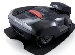
**Automower** - Wenn die Batteriekapazität des Automowers niedrig ist, findet er selbstständig seinen Weg zur Ladestation.
